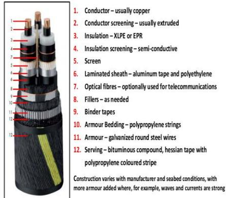
Gambar 1. Konstruksi Kabel Laut
